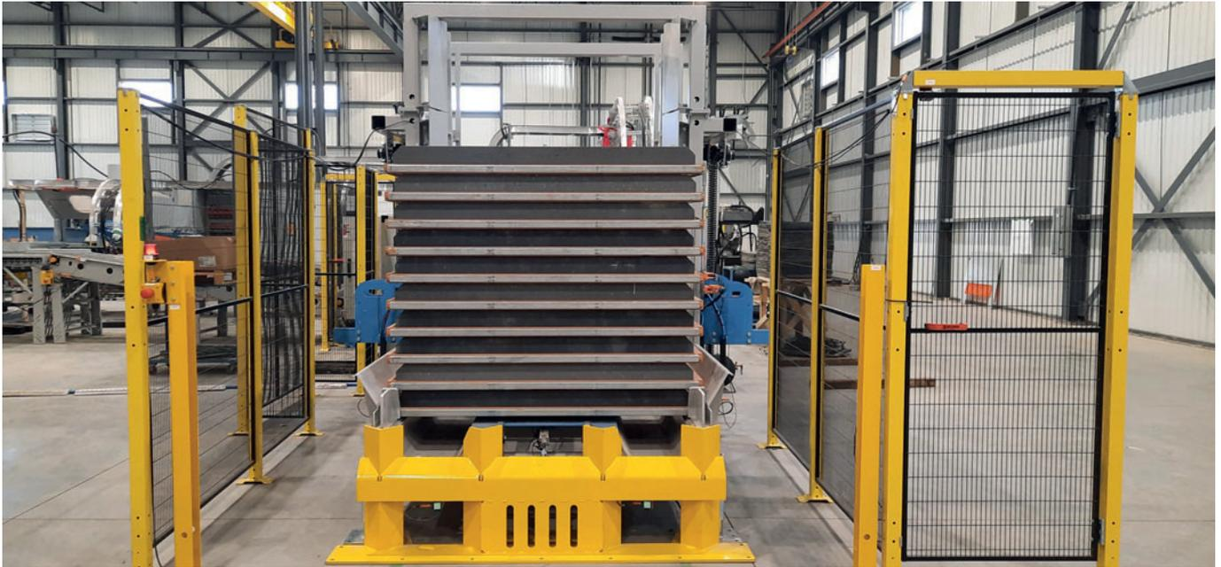
*SystemBoard – опорное решение для штабелей на вибролитьевой линии Automacad*
