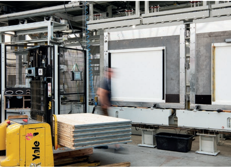
Núcleos de madera maciza antes del proceso de recubrimiento con poliuretano en Wasa en Neubrunn, Turingia
