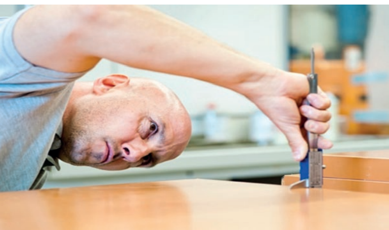
Altas exigencias en la gestión de la calidad: cada bandeja Wasa Woodplast es medida para comprobar que se cumplen las tolerancias dimensionales antes de su envío
