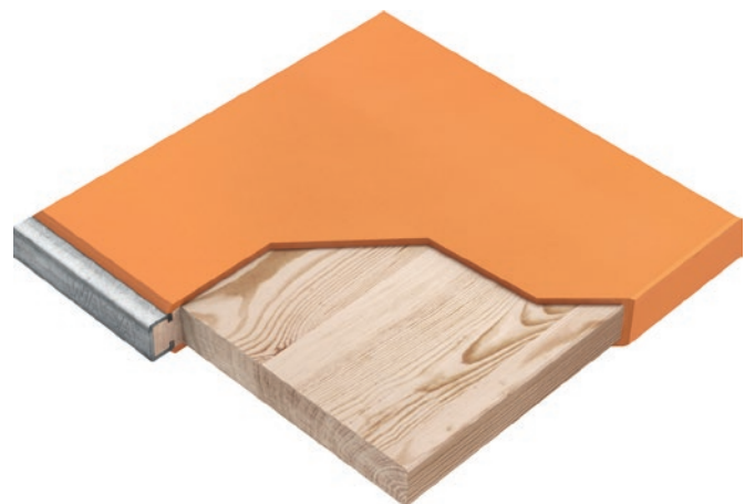
Vista del interior de una bandeja Wasa Woodplast. Orientación de los tablones perpendicular a la dirección de producción. Los tablones individuales están separados entre sí por tiras de poliuretano.
