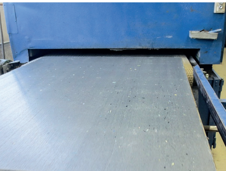
Une ancienne planche Wasa Uniplast après le processus d'étalonnage, dans de nouvelles dimensions
