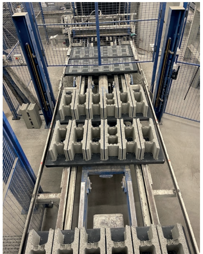
Compactage optimal et hauteur uniforme des produits grâce aux nouvelles planches en plastique pleine masse sur l'installation Quadra Q6
