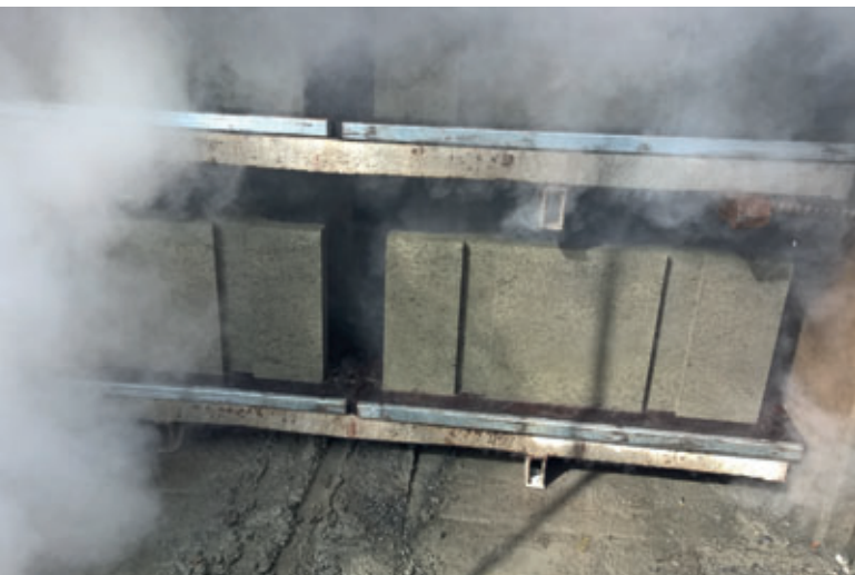
Dampfeinleitung in der Aushärtekammer: direkt auf die Unterlagsplatten gerichtete Dampfdufen sind zu vermeiden.
