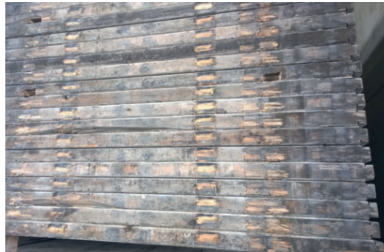
Gestapelte Unterlagsplatten mit deutlich sichtbaren Spuren der Transportklinken
