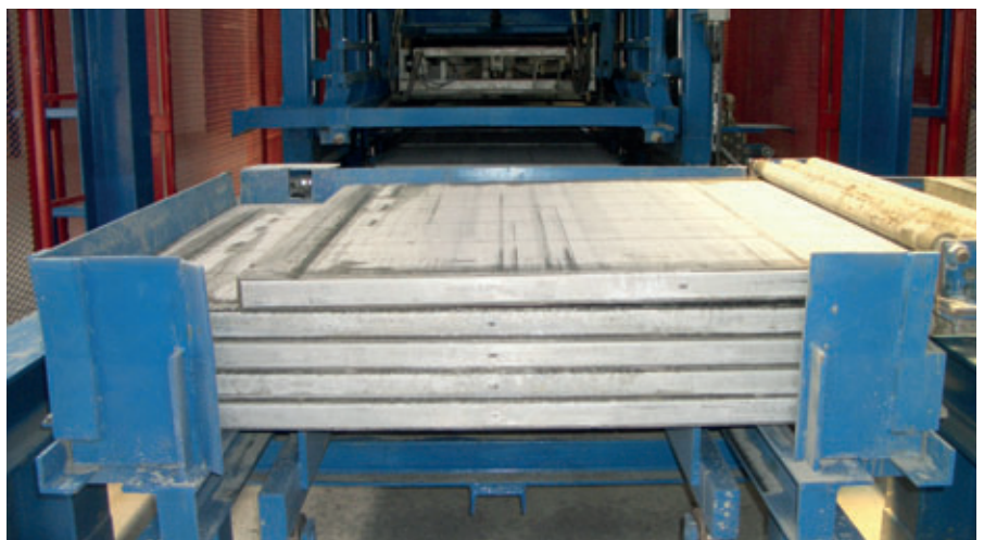
Brettmagazin vor der Maschine
