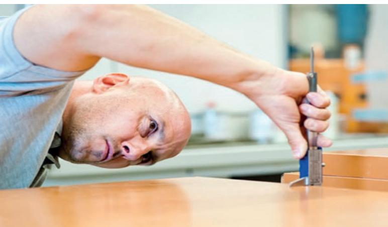
*Высокие требования к контролю качества: перед отгрузкой каждый технологический поддон Wasa Woodplast измеряется на соответствие размерным допускам*
