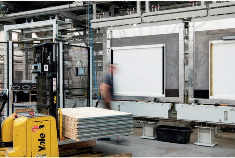
*Древесные сердечники из массива перед нанесением полиуретанового покрытия на заводе Wasa в Нойбрунне, Тюрингия*
