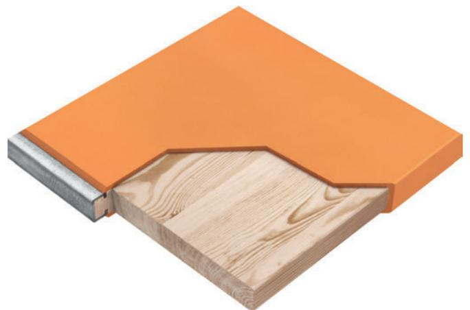
*Вид на внутреннюю часть Wasa Woodplast. Расположение досок поперек направления производства. Отдельные доски изолированы от друга полиуретановыми прослойками*
