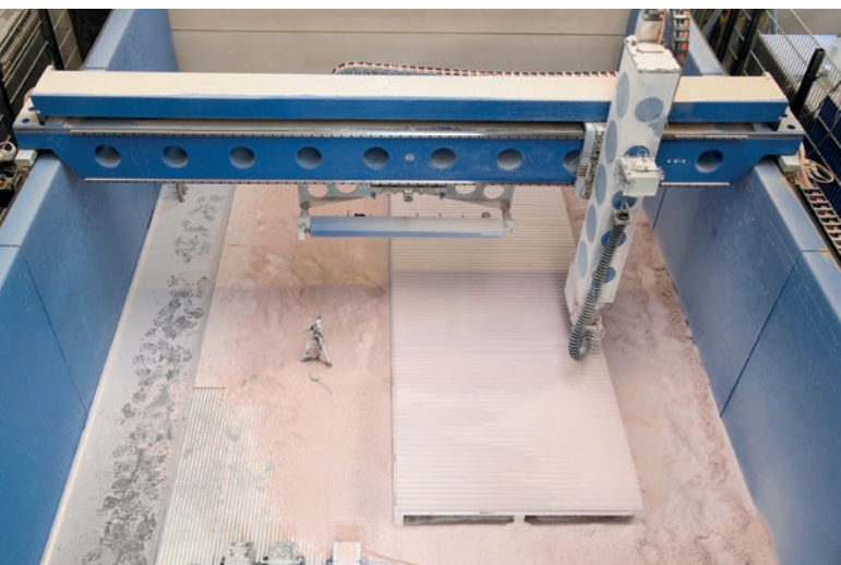
Usinage CNC du bloc en PU, dimensions du modèle 3 600 x 1 500 mm. La structure est fraisée dans le bloc par une fraiseuse à portique 5 axes ultramoderne.
