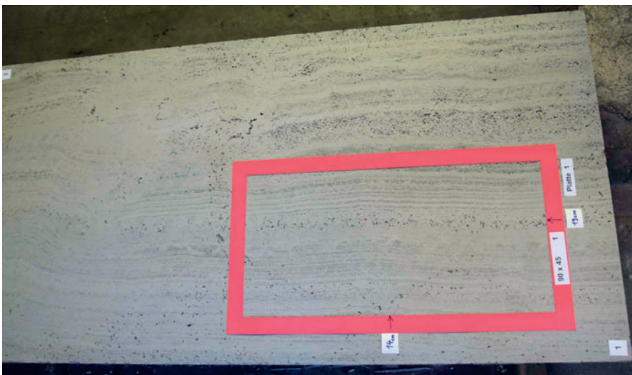
Auf der gegossenen Betonplatte 2,0 m x 1,0 m werden verschiedene Oberflächen und Gesichter für das Steinsystem ausgewählt.
