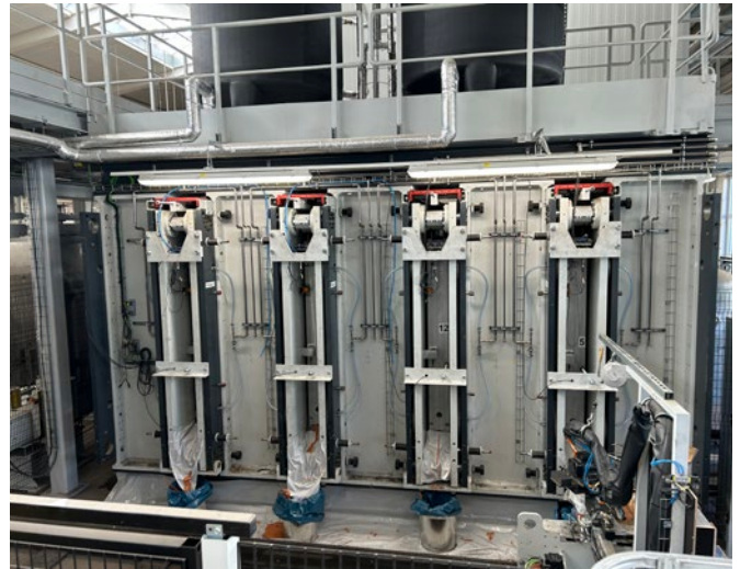
In den Pressstationen wird das flüssige Polyurethan mit hohem Druck in die Form gepresst.
