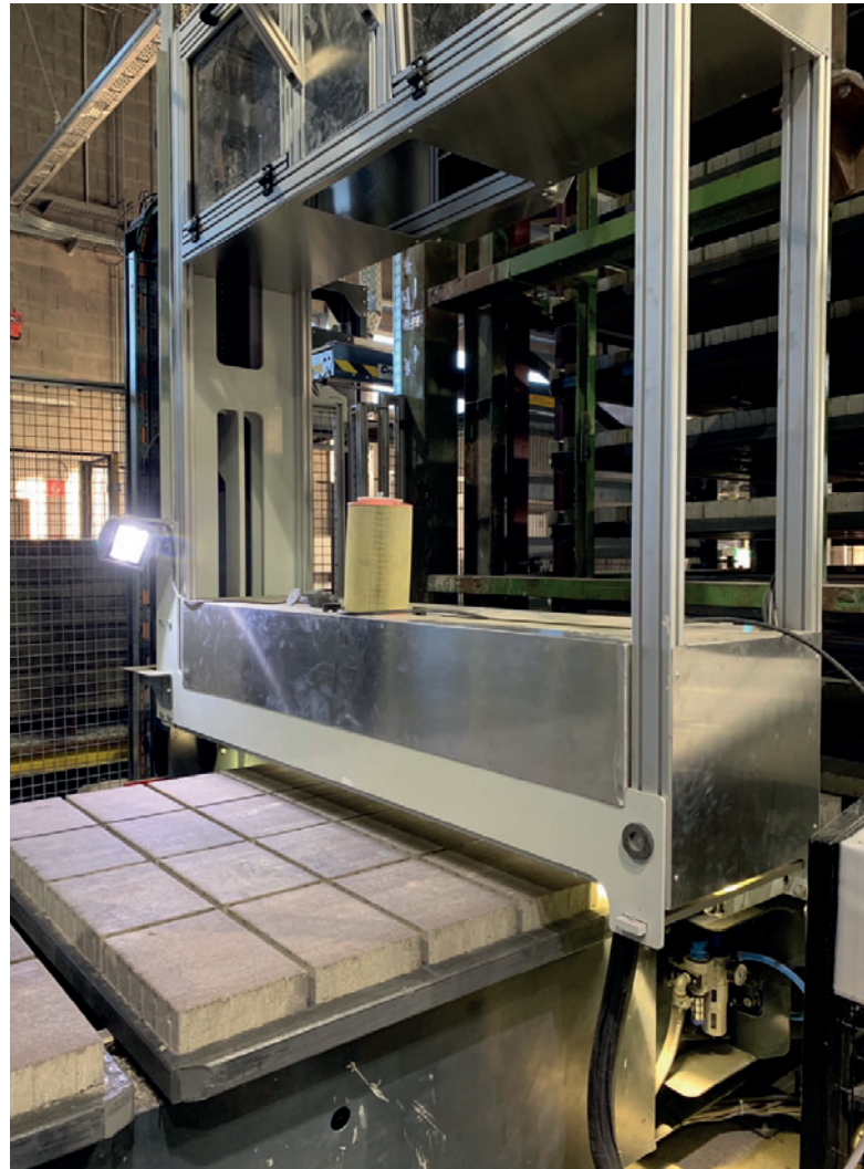
Fugenlose und planebene Oberflächen der Wasa-Vollkunststoffplatten für beste Steinunterseiten
