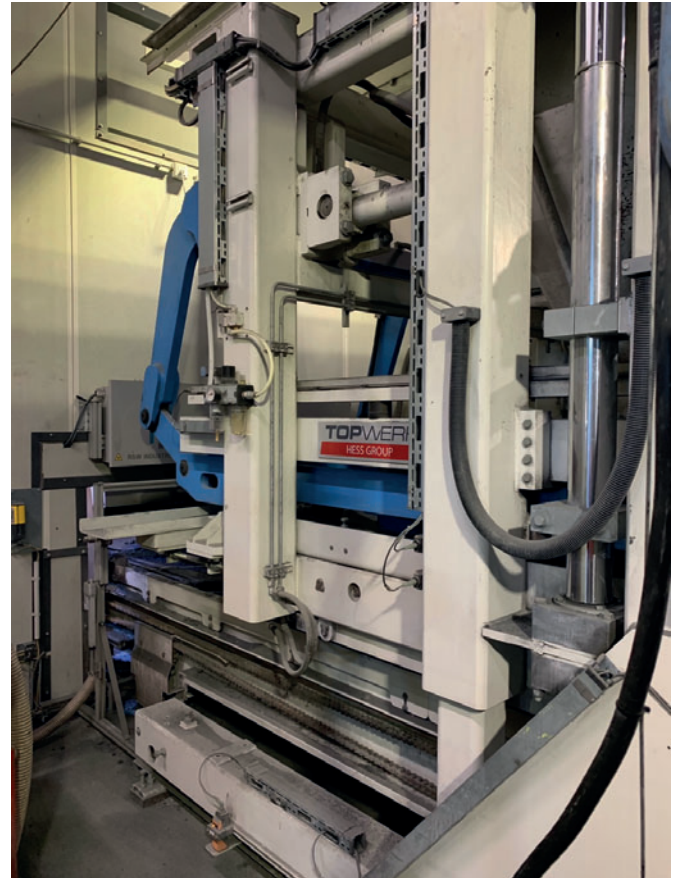
Als Steinfertiger dient eine Hess RH 1500 der neuesten Generation mit den Plattenmaßen 1.450 x 980 x 52 mm.
