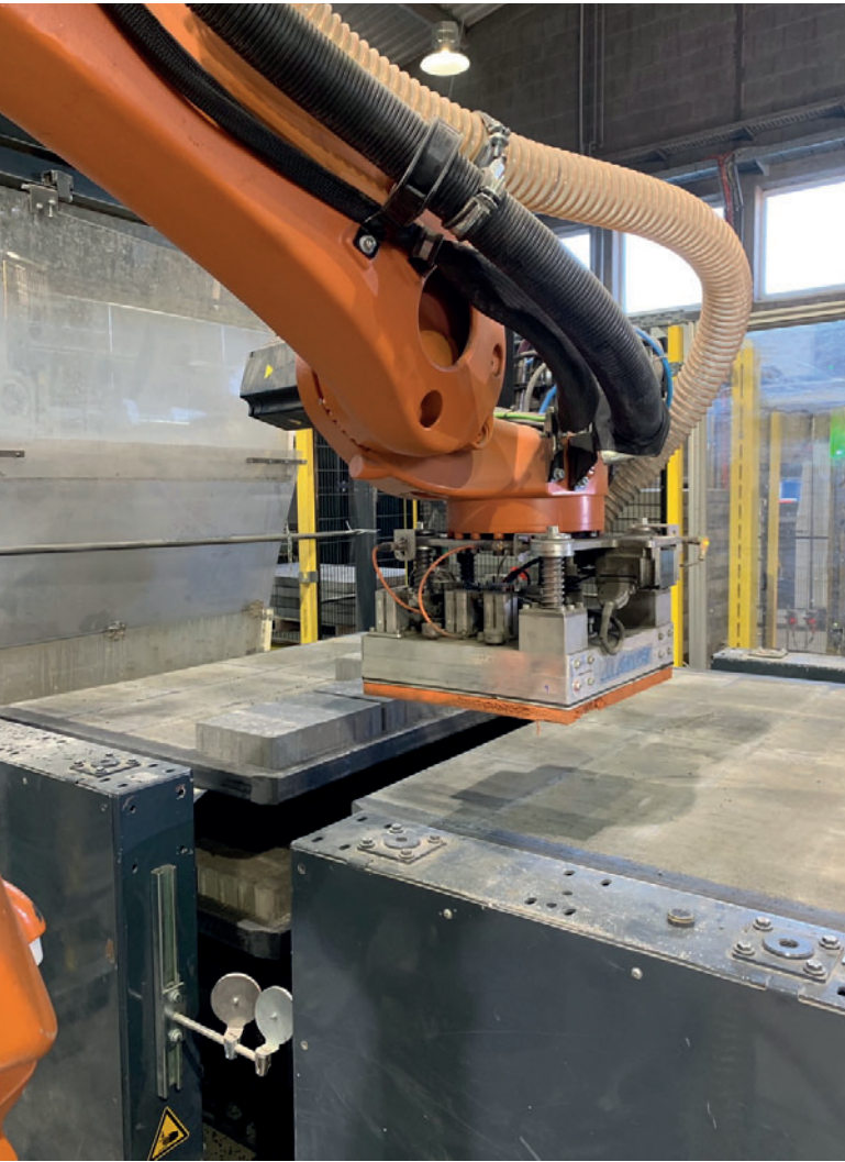
Vollautomatischer Roboter auf der Trockenseite zur Qualitätskontrolle
