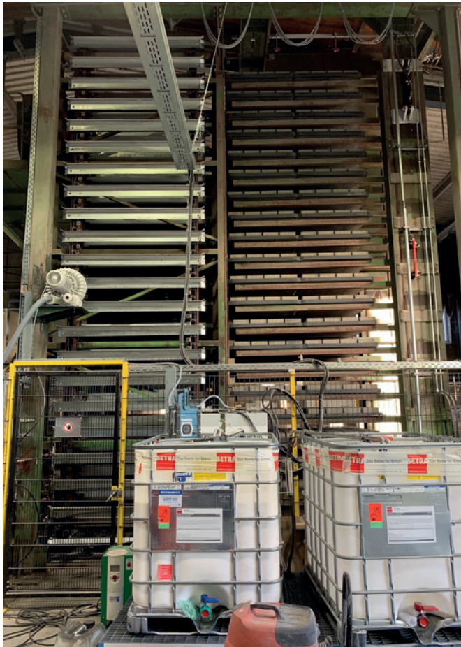
Hub- und Senkleiter mit produzierten Steinen auf den Wasa Uniplast Ultra
