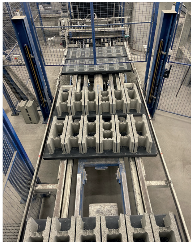
Высокая степень уплотнения и единая высота изделия благодаря новым цельнопластиковым технологическим поддонам на линии Quadra Q6
