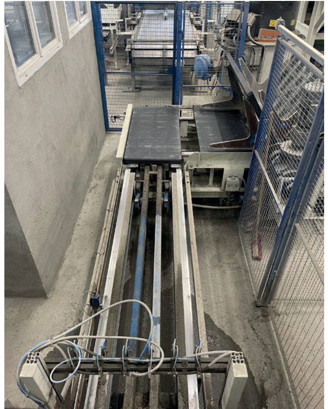
Линия оборотных поддонов Quadra Q6 с современными поддонами Wasa Uniplast Ultra
