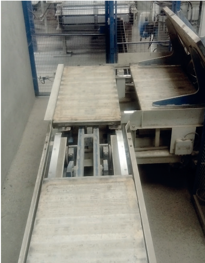
Линия оборотных поддонов Quadra Q6 с прежними деревянными поддонами
