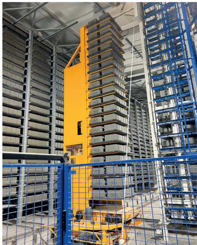
Камера выдержки нового завода Quadra Q12 с поддонами Wasa Uniplast Ultra
