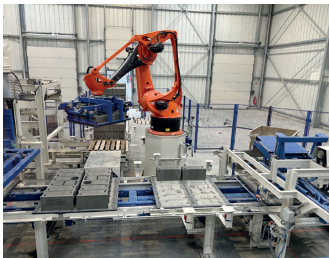
Робот-манипулятор на современной линии оборотных поддонов Quadra Q12
