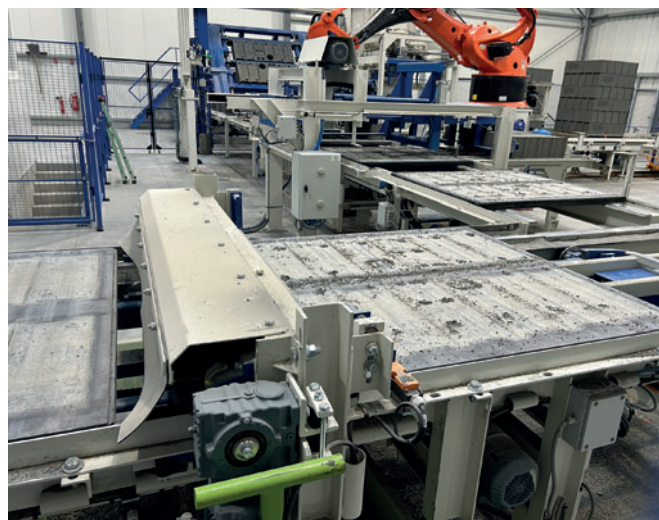
Тщательный уход за Wasa Uniplast Ultra благодаря очистке поддонов на линии Quadra Q12
