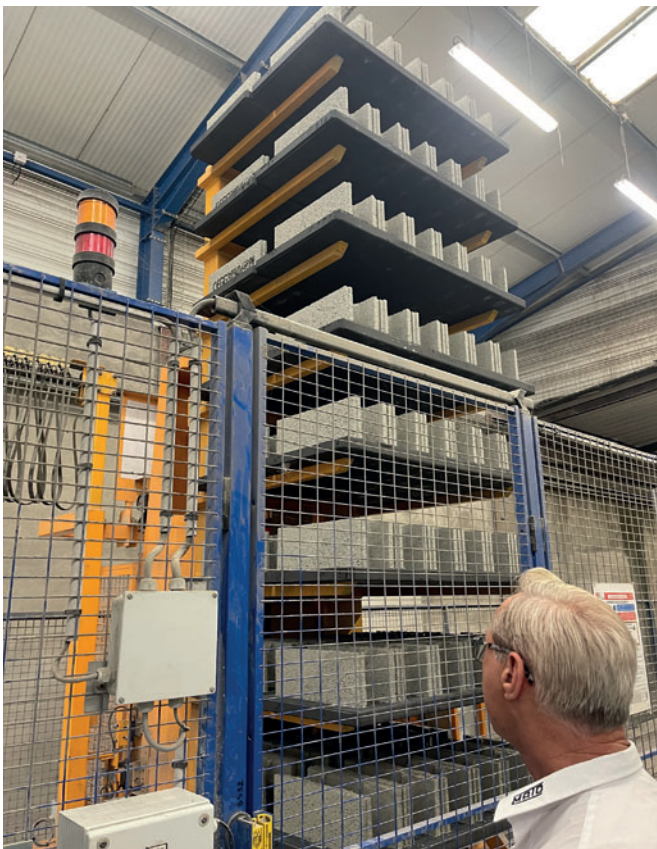
Линия оборотных поддонов Quadra Q6 с поддонами Uniplast Ultra
