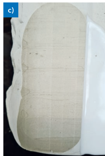
Abb. 7: Fräsbearbeitung eines extrudierten Probekörpers (a) bei anschließender Abformung mit einem Gießharz [(b) und (c)]
