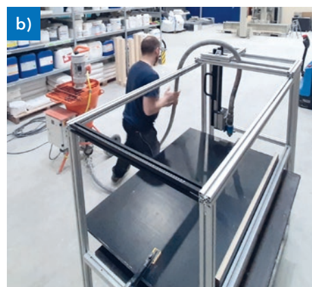
(b) Versuchsaufbau teilautomatisierter Extrusion
