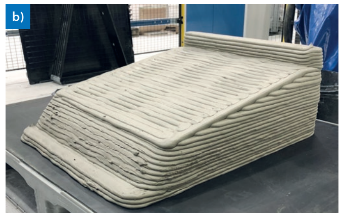
Abb. 6: Quarzkies in den Hohlräumen (a) ermöglicht Gewichtsreduktion des extrudierten Körpers (b)
