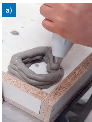
(a) Händische Extrusion
