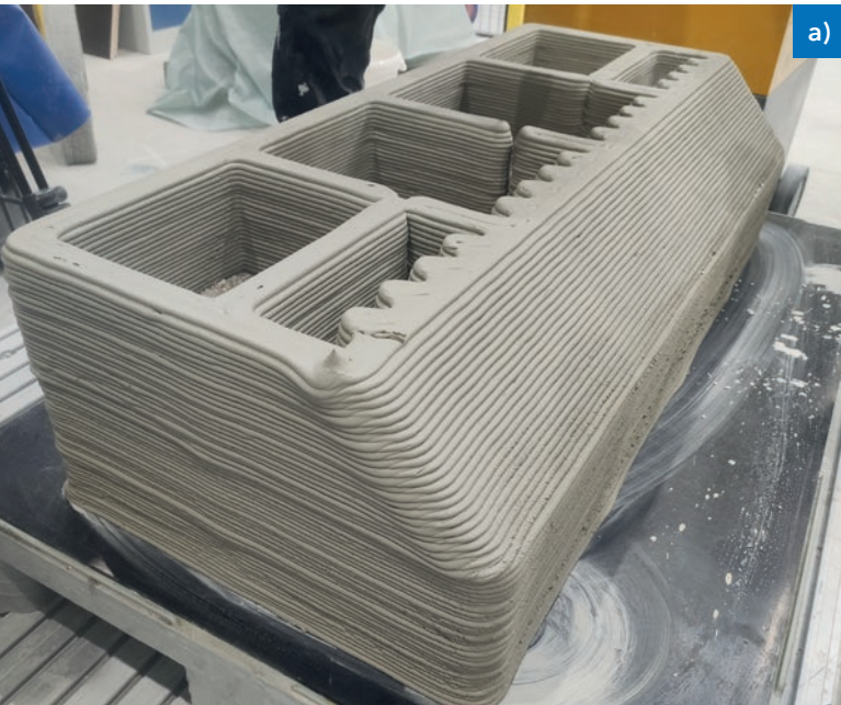
Abb. 11: Betonbordstein mit Schüttkammern (a) und final extrudiert (b)
