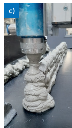
(c) teilautomatisierte Extrusion
