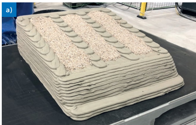
Abb. 6: Quarzkies in den Hohlräumen (a) ermöglicht Gewichtsreduktion des extrudierten Körpers (b)
