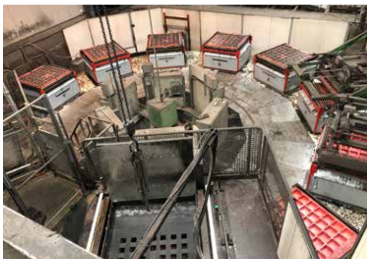
Fig. 3: Wet-cast carousel system for small-sized concrete products: face mix concrete is filled in the multiple mold and core concrete is also filled in Abb. 3: Karussell Wetcast Anlage für Kleinformatige Betonwaren: über einen Füllwagen werden der Vorsatz- und der Kernbeton in die Mehrfachform gefüllt
