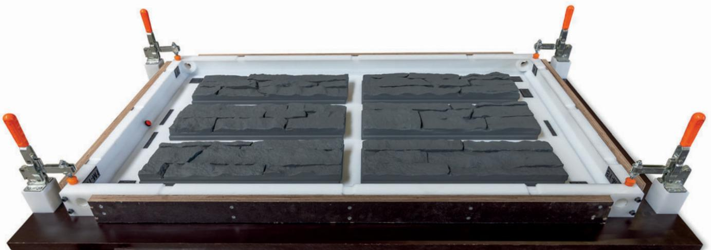
*Модель для отливки, рама для отливки и отдельные модели были изготовлены с помощью точной обработки на станках с ЧПУ, что позволило придать каждой модели точно заданный объем. Это обеспечивает стабильное качество изделий и упрощает последующий производственный процесс*
