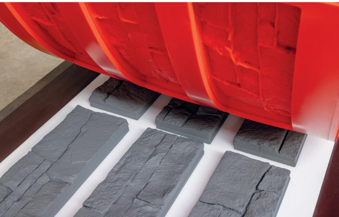
Обладая средней твердостью A45 по Шору, этот материал предлагает идеальное сочетание гибкости, стабильности размеров и долговечности. Полиуретановая форма снимается после 24 часов отверждения при температуре 20°C
