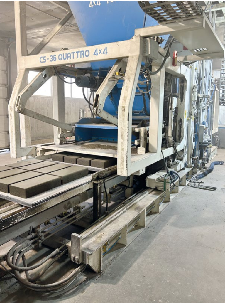
La instalación antigua ya está fabricando bloques con bandejas de Wasa
