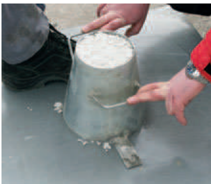
Natürlich wurde von Profilbeton auch das Ausbreitmaß der ersten Betonmischung normengerecht ermittelt.
