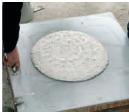
Natürlich wurde von Profilbeton auch das Ausbreitmaß der ersten Betonmischung normengerecht ermittelt.
