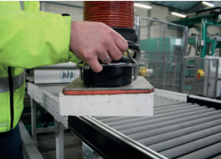
Die fertigen Produkte werden mit dem Vakuumheber von Timmer vom Pufferband der Slabflex entnommen.
