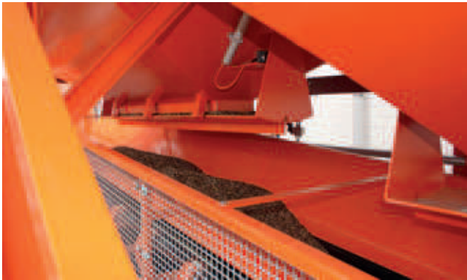
Einer der drei elektro-pneumatisch betriebenen Segmentdosierschlüsse
