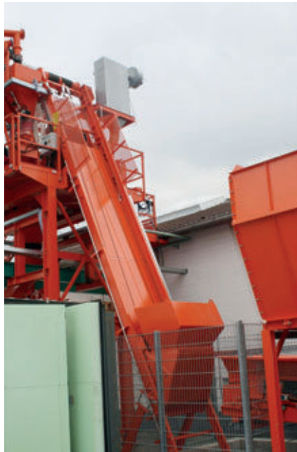
Der Beschickungsaufzug ist mit einer Absturzsicherung versehen.
