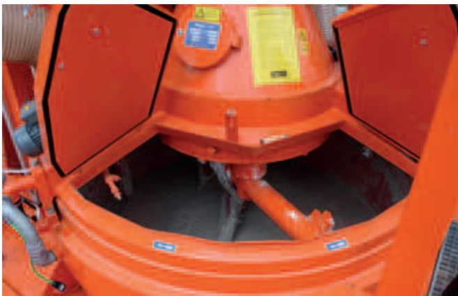
Planeten-Gegenstrommischer HPGM 750 mit einem Mischerstern und zwei Mischerschaufeln
