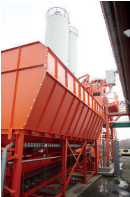
Das Wiggert-Reihensilo 3-35-WB 600 verfügt über drei Kammern mit einem Gesamtfassungsvermögen von 35 m 3 .
