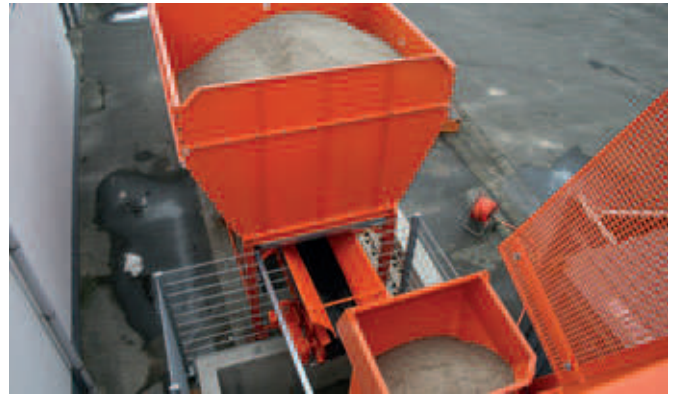
Über eine Profilstahlfahrbahn wird der Beschickungsaufzug in die Mischerebene gezogen.
