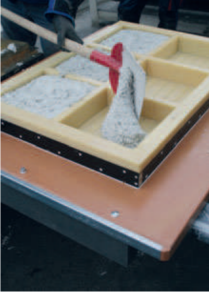
Manuelle Probefüllung einer Wetcastform von Wasa
