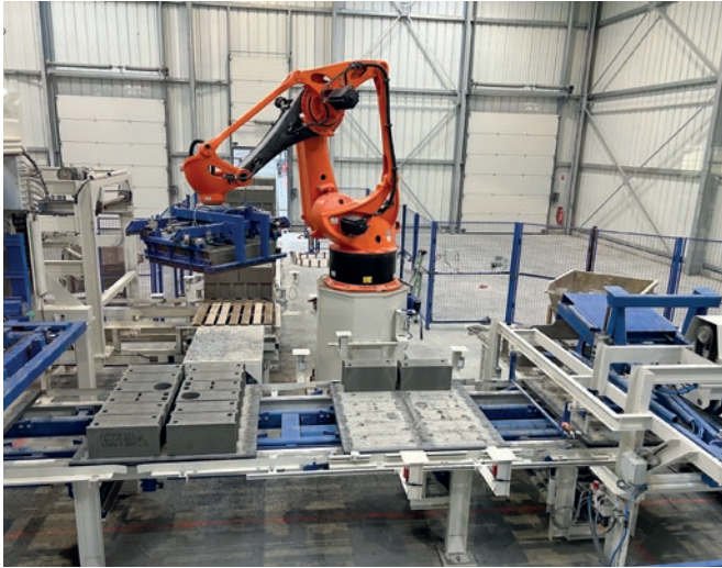
Roboter-Handling im modernen Umlauf der Quadra Q12 Anlage
