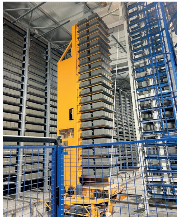
Die Härtekammer der neuen Quadra Q12 mit Wasa Uniplast Ultra Platten
