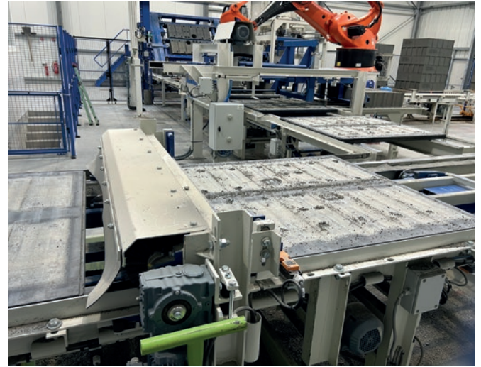
Gründliche Pflege der Wasa Uniplast Ultra durch die Plattenreinigung in der Quadra Q12 Anlage
