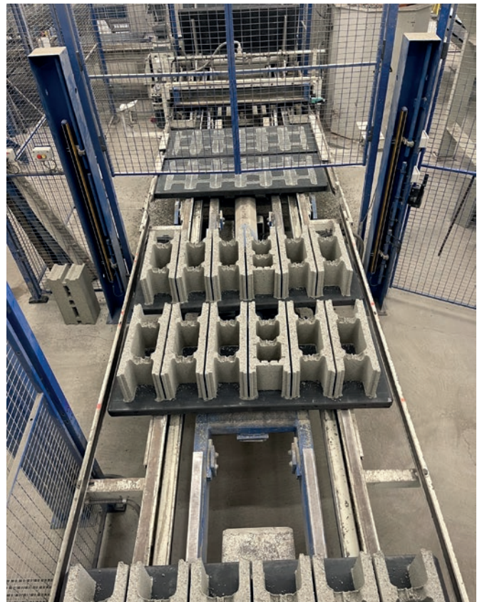
Sehr hohe Verdichtung und einheitliche Höhe der Produkte durch die neuen Vollkunststoffplatten auf der Quadra Q6 Anlage
