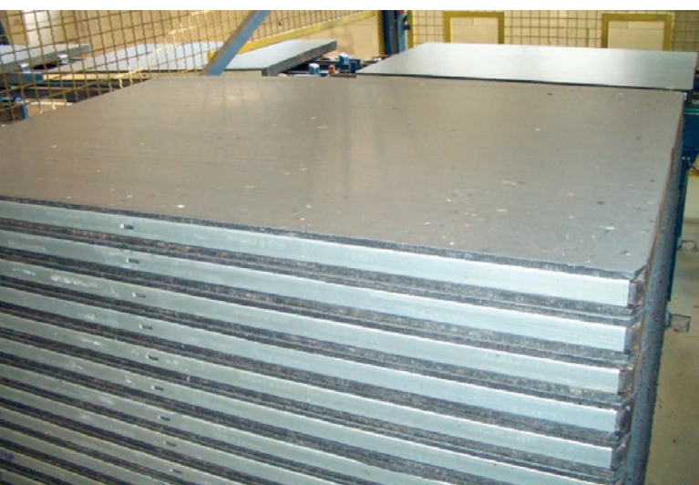
Superficie de una bandeja Wasa Uniplast rectificada después de haber sido utilizada durante 14 años
