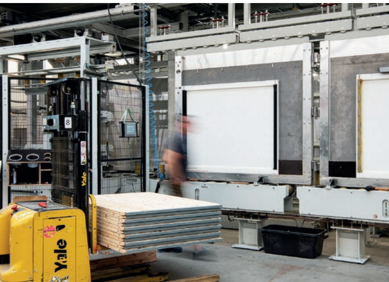
Vollholzkern vor dem Polyurethan-Beschichtungsvorgang bei Wasa im thüringischen Neubrunn
