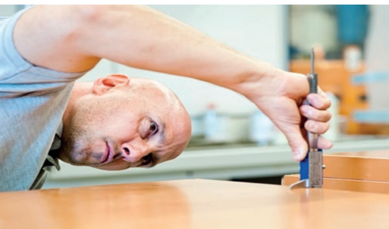
Hohe Anforderungen an das Qualitätsmanagement: Jede einzelne Wasa Woodplast wird vor ihrem Versand auf die Einhaltung ihrer Maßtoleranzen vermessen.
