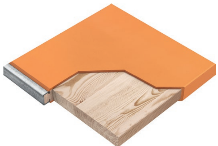
Ansicht in das Innere der Wasa Woodplast. Bohlenausrichtung quer zur Produktionsrichtung – Einzelbohlen sind mittels Polyurethanstreifen voneinander separiert.
