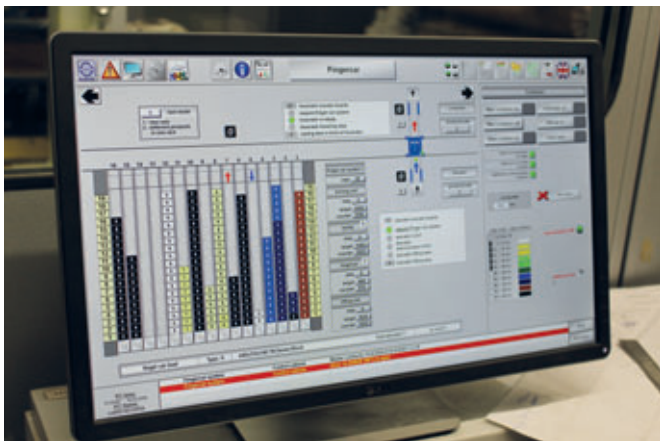
Bedienstation der neuen Betonsteinanlage, von der aus alle wichtigen Parameter gesteuert werden können. So zum Beispiel das Lagermanagement der Aushärtekammer.
