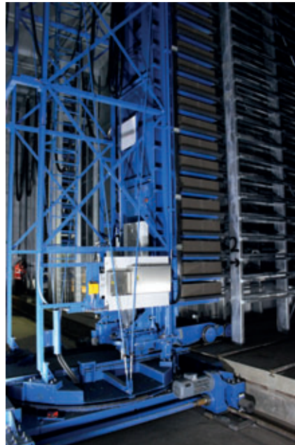
Der Gabelwagen entnimmt die ausgehärteten Produkte aus der Regalkammer.
