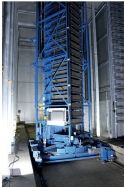
Während der Fahrt rotiert die Plattform des Gabelwagens um 180°.
