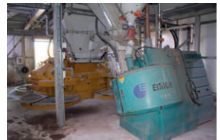
Ein Haarup- und ein Eirich-Mischer versorgen den Betonsteinfertiger mit Kern- und Vorsatzbeton.
