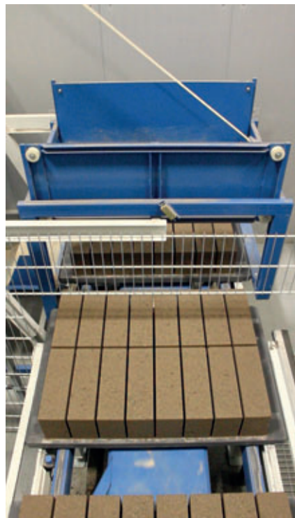
Die Unterlagsplatten mit den frischen Betonwaren werden per Bandförderer in die in der Aushärtekammer befindlichen Hubleiter eingefahren.
