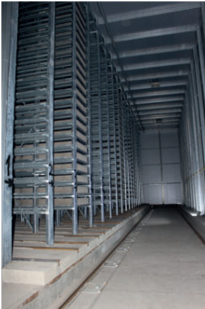
Insgesamt 6.688 Unterlagsplatten können in der Großraum-Klimakammer gleichzeitig gelagert werden.
